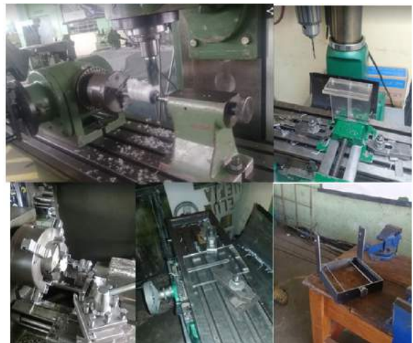
Figura 7 Mecanizado y montaje de partes para CNC router
