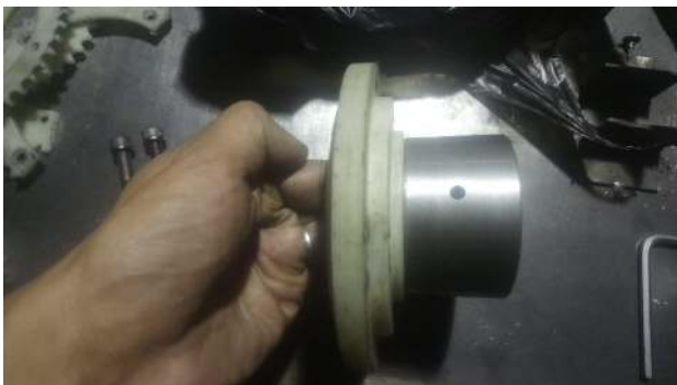
Fig. 8: Mecanización del porta catalinas.
