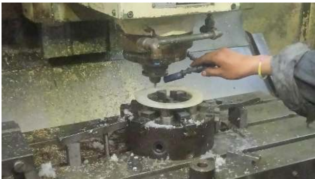
Fig. 7: Mecanización de la catalina
