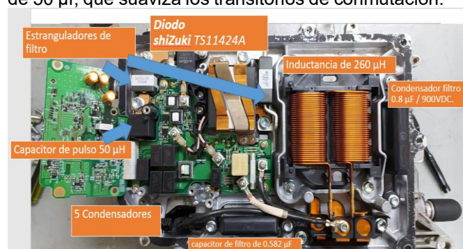
Figura. 10. Zona de Convertidor booster Bidireccional.
