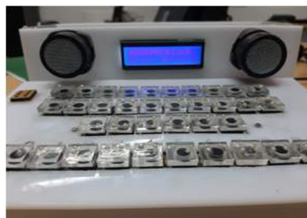
Figura 17. Ubicación bocinas y pantalla LCD
