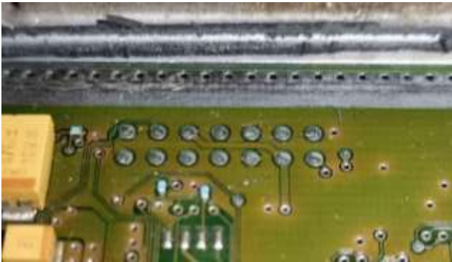
Figura 5. Puerto BDM en PCB de ECM Bosch MED 17.4 de Peugeot 207.
