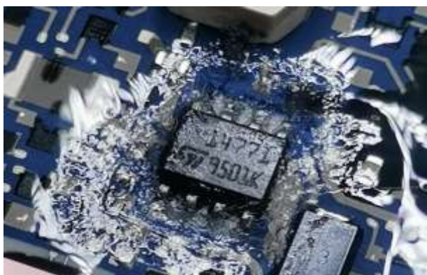
Figura 10. Desoldado de memoria EEPROM ST9501K de ECM Híbrida Delphi HV-340 de Chevrolet Corsa Evolution 2006 para posterior lectura con VVDI-Prog
