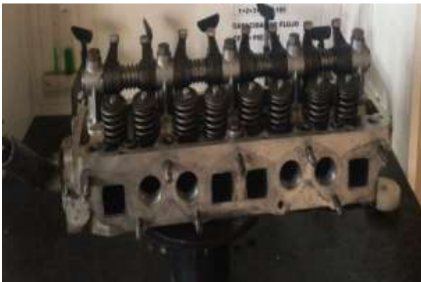
Figura 7. Cabezote sujetado al cilindro adaptador
