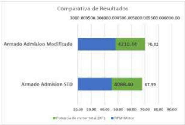
Figura 13. Comparativa del armado Admisión STD y Modificado
