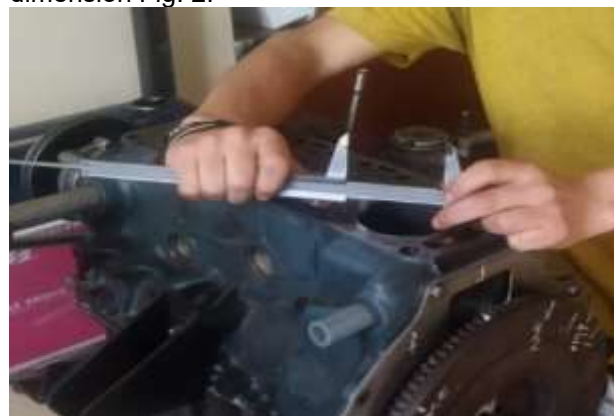
Figura 1 Medición del Cilindro
