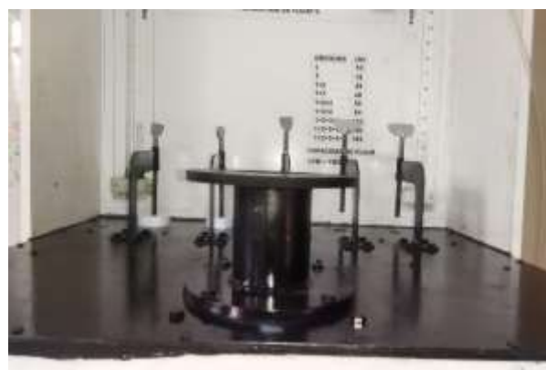
Figura 2 Adaptación del cilindro al flujómetro
