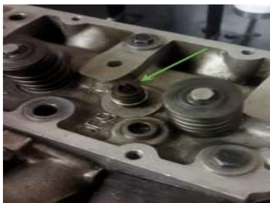
Figura 4 Guía de válvula tapada.
