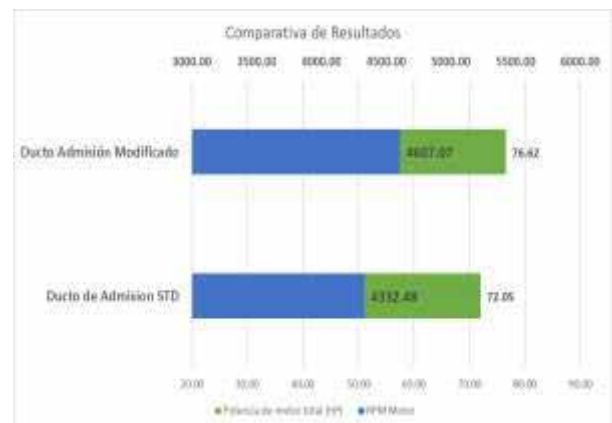
Figura 11. Comparativa del Ducto Admisión STD y Modificado
