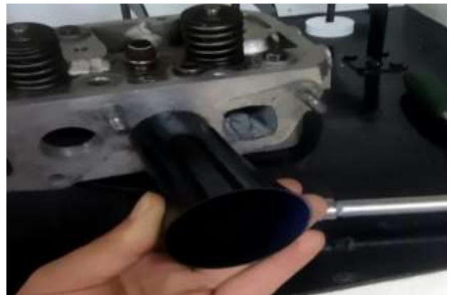
Figura 10. Coloca el Cono para que no haya turbulencia
