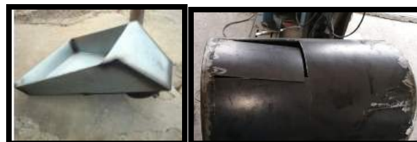
Figura 5. Sistema receptor, tolva y cilindro.
