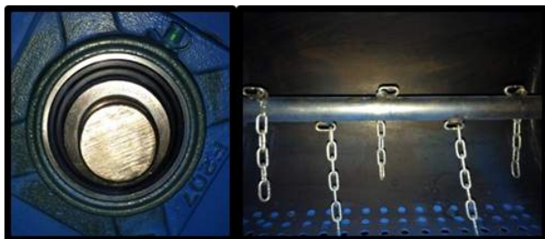
Figura 7. Sistema desgranador, cilindro y cadenas.
