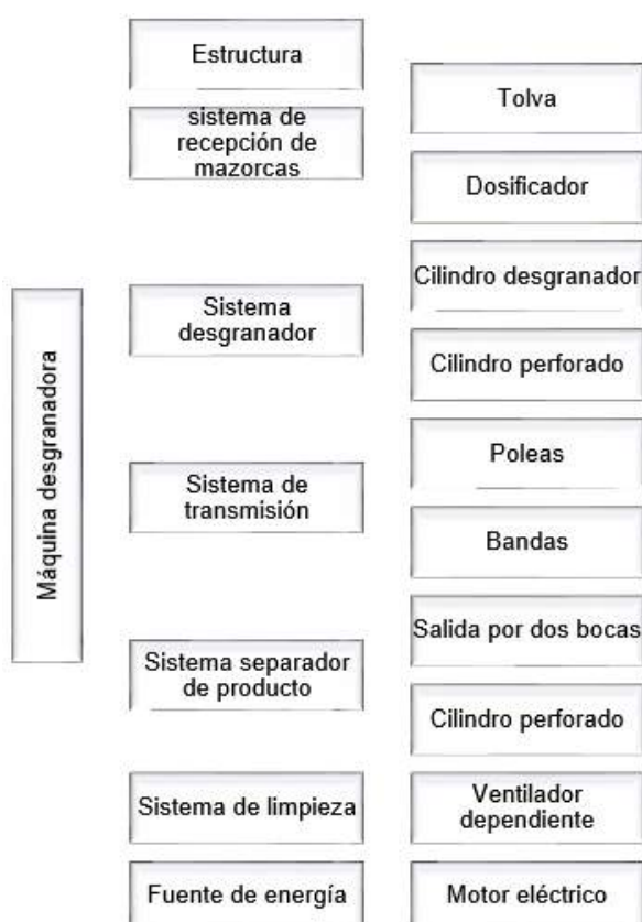
Figura 2. Sistemas para máquina desgranadora
