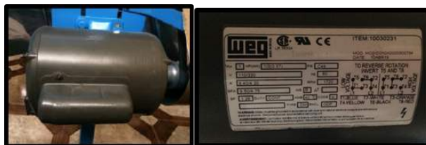
Figura 8. Fuente de energía, motor de \frac{1}{2} HP
