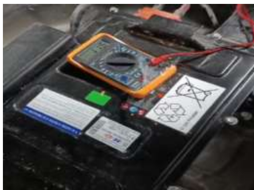
Figura 5. Verificación de voltaje de 12 voltios con conectores desconectados.
