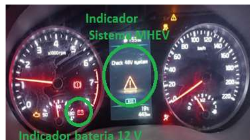
Figura 3. Indicador 12 V y 48 V Kia Stonic
