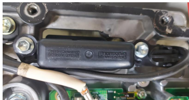
Figura 4. Capacitores externos de 0,8 uf
