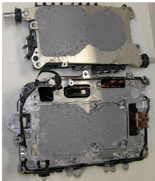
Figura. 8. Pasta térmica que aísla los IGBT de la carcasa.
