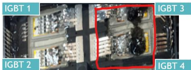
Figura. 18. IGBT del área CC/CC
