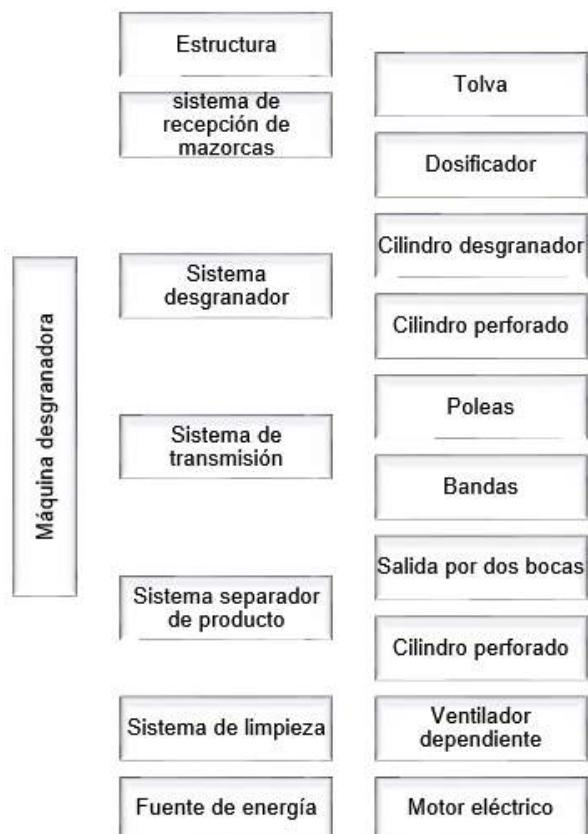
Figura 2. Sistemas para máquina desgranadora
