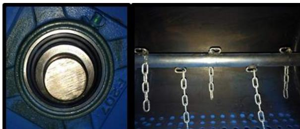
Figura 7. Sistema desgranador, cilindro y cadenas.
