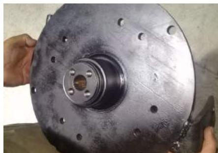
**Figura 4.** Parte del acople para la caja de cambios al motor eléctrico
