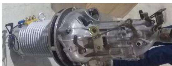
**Figura 5.** Motor eléctrico acoplado a la caja de cambios
