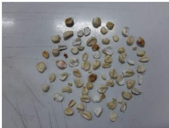
Figura 21. Muestra general de granos en mal estado, después de desgranado automático.
