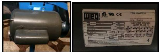
Figura 8. Fuente de energía, motor de  $\frac{1}{2}$  HP
