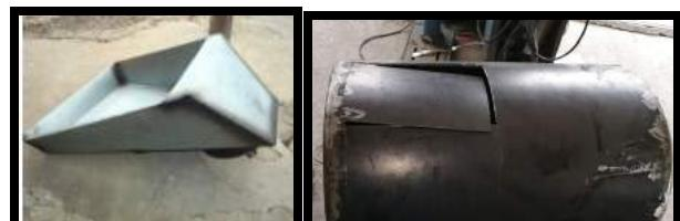
Figura 5. Sistema receptor, tolva y cilindro.
