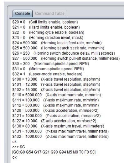
Figura 13. Parámetros a configurar en el software
