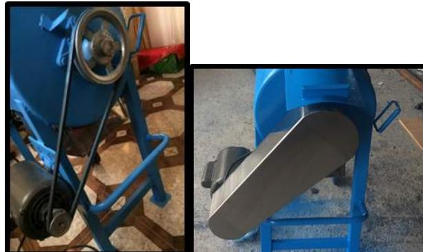
Figura 9. Sistema de transmisión y protección
