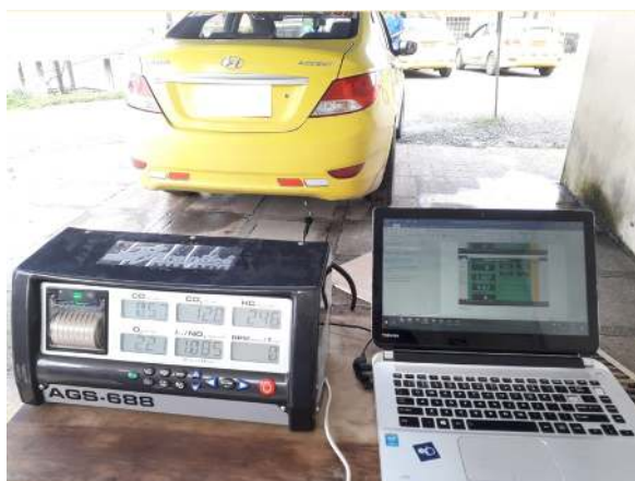
Fig.1: Mediciones de gases de escape.
