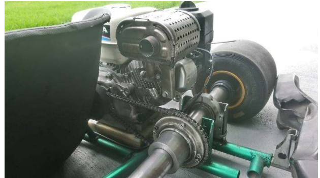
Fig. 9: Sistema de transmisión instalado.
