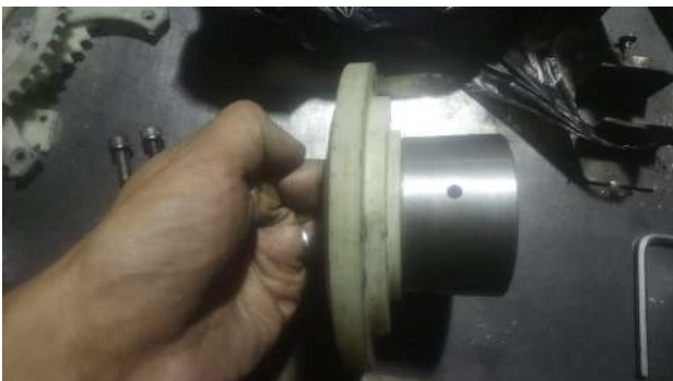
Fig. 8: Mecanización del porta catalinas.
