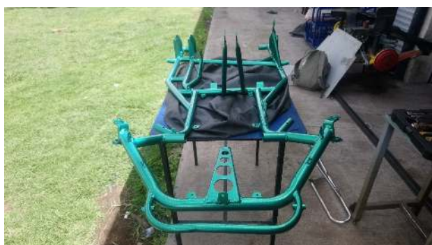
Fig. 2: Estructura del chasis en el que se implementa el Kart.
