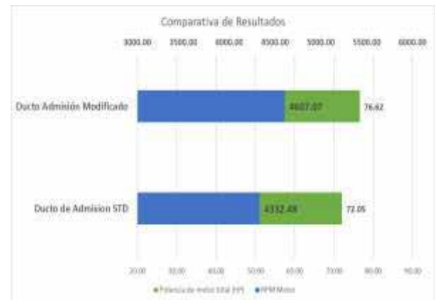
Figura 11. Comparativa del Ducto Admisión STD y Modificado
