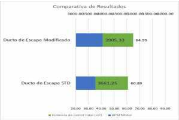
Figura 12 Comparativa del Ducto de escape STD y Modificado En la Fig.12 se compara el ducto de escape estándar y el ya modificado, al analizar los datos vemos una mejora significativa en la potencia, llevando consigo una mejora del 6,67% de flujo en el ducto.
