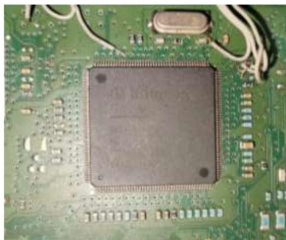
Figura 9. Conexión para Boot Mode de MCU Infineon TriCore TC1766 de ECM Delphi MT-60 correspondiente a Chevrolet Sail 2013, lectura posterior por CAN Bus mediante VVDI-Prog.
