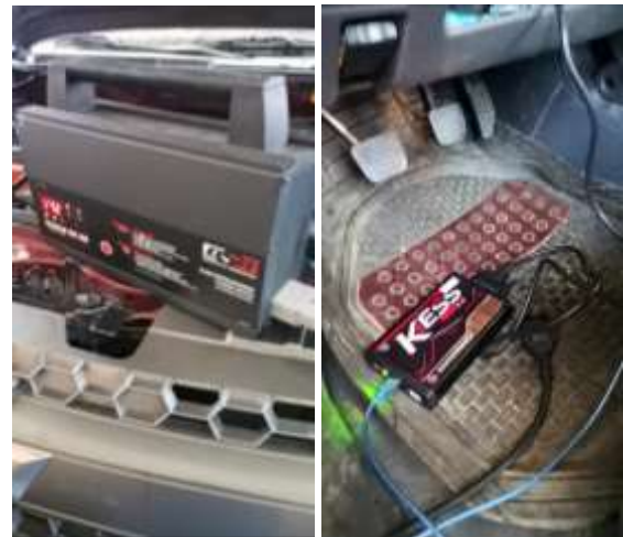
Figura 4. Extracción de información de ECM Transtron 8982107100 de Isuzu DMax 3.0 2016 mediante Kess, respaldo de batería con estabilizador de tensión Schumacher INC-100
