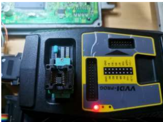
Figura 11. Lectura de memoria EEPROM 93C66 extraída de ECM Hitachi A56-Y32 de Nissan X-Trail 2010 mediante VVDI-Prog.
