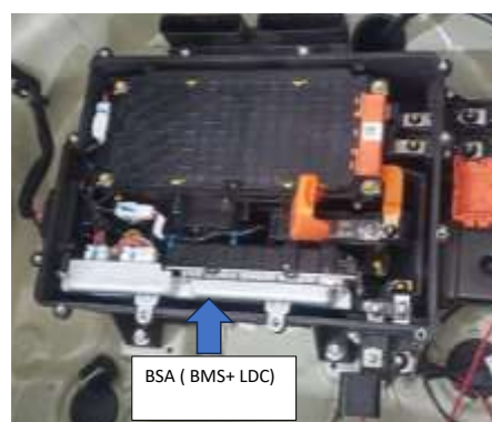
Figura 6. Ubicación del módulo BSA (BMS +LDC) en el pack de baterías de 48 V.
