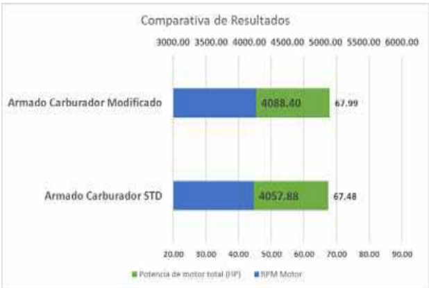
Figura 15. Comparativa del armado Carburador STD y Modificado
