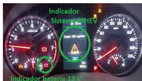
Figura 3. Indicador 12 V y 48 V Kia Stonic
