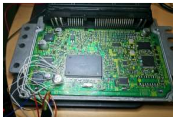
Figura 8. Lectura de ECM Hitachi A56-Y32 de Nissan X-Trail 2010 soldando líneas dedicadas utilizando K-Tag.
