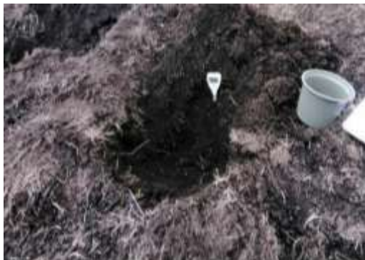
Fig. 2: Muestreo a 20 cm profundidad
