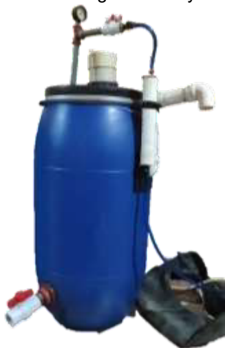
Figura 1. Biodigestor tipo Batch usado en el experimento.
